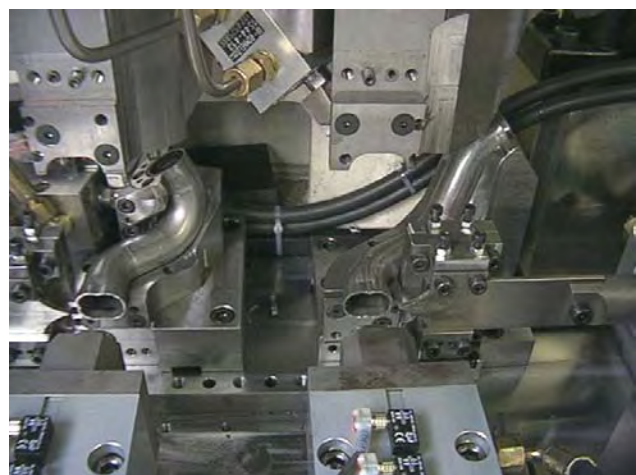
Schneidewerkzeug zum Beschneiden der Rohrenden (hier Bearbeitung zweier unterschiedlicher Rohre in einem Arbeitsgang)
