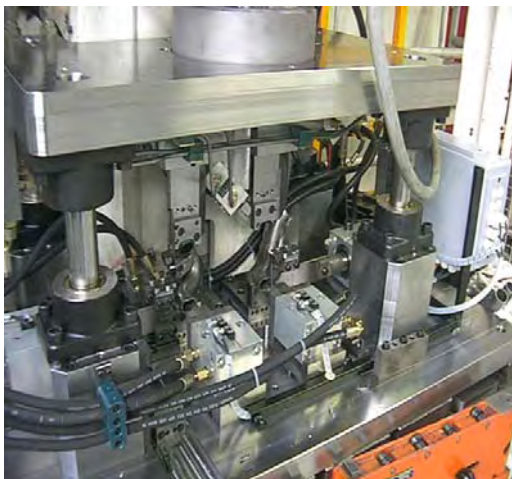
Schneidewerkzeug zum Beschneiden der Rohrenden (hier Bearbeitung zweier unterschiedlicher Rohre in einem Arbeitsgang)
